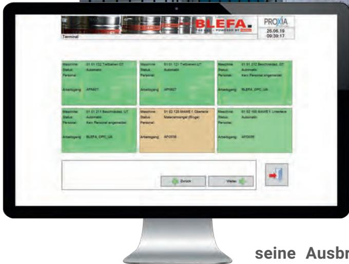
**Blefa Beverage Systems nutzt für die Anbindung seiner Produktionsmaschinen das MDE/BDE-System von Proxia mit OPC-UA-Datenkommunikation. Jetzt kann der Hersteller von Edelstahlfässern seine Ausbringungsmenge stückzahlgenau berechnen – und kommt zudem auf 15 Prozent mehr als vor dem Softwareprojekt.**
