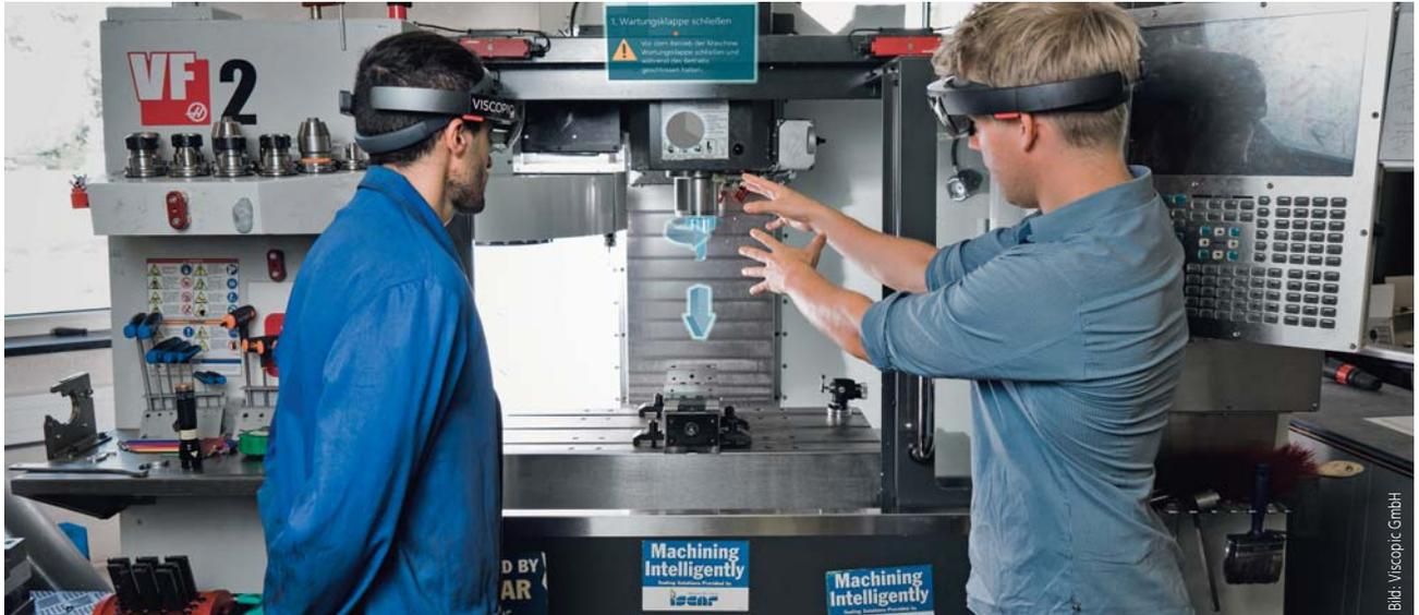
Viscopic Pins in der Anwendung, um mit der Microsoft Hololens virtuelle Arbeitsschritte punktgenau auf das reale Objekt zu projizieren
